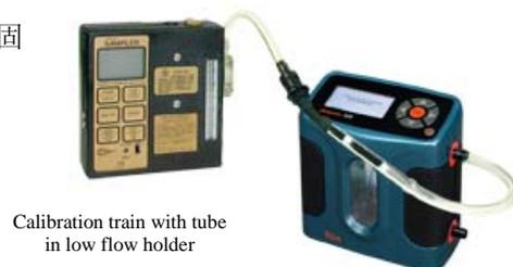
松开低流量固定器的螺母帽.按气流和电池检查键激活泵.
