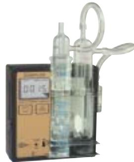
*Impinger-Halter an Pumpe mit Impinger und Falle*
