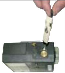
*Für hohen Durchfluss die Ventilschraube nach rechts drehen.*
