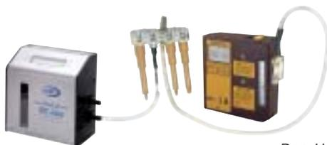
*Den Halter am Pumpeneingang und den Röhrrcheneingang am Strömungsmesser anschließen.*
