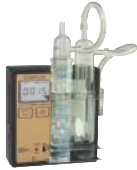
Étui à impacteur sur la pompe, avec impacteur et barboteur
