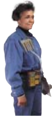
Halter am Mitarbeiter festklemmen und Pumpe am Gürtel anbringen.
