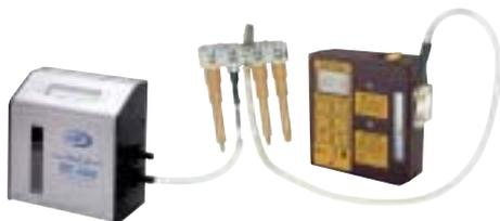
*Branchez le support à l'arrivée de la pompe et l'entrée du tube au débitmètre.*
