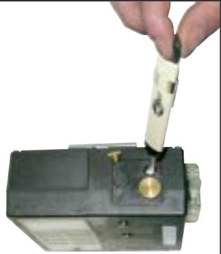
*Para fijar un flujo bajo, gire el tornillo de la válvula hacia la izquierda.*
