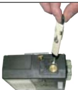
*Para fijar un flujo alto, gire el tornillo de la válvula hacia la derecha.*
