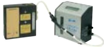
*Tren de calibración con un tubo en el portador*
